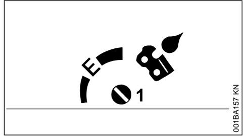
Mit dem Einstellbolzen (1) (an der Unterseite der Maschine) kann die Ölfördermenge je nach Bedarf reguliert werden.
