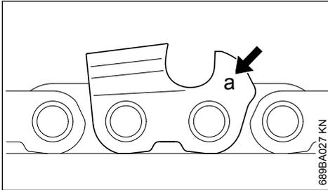
Die Kennzeichnung (a) der Kettenteilung ist im Bereich des Tiefenbegrenzers jedes Schneidezahnes eingepreßt.
