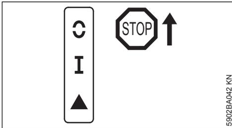
**STOP** bzw. 0 – zum Ausschalten der Zündung muss der Kombihebel in Richtung **STOP** bzw. 0 gedrückt werden. Nach Loslassen federt der Kombihebel in die Betriebsstellung **I** zurück.
